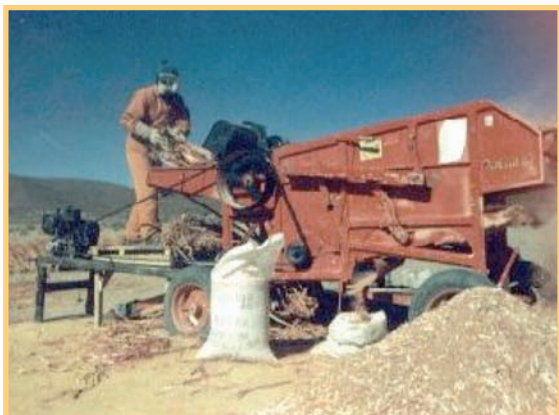
Foto 24 Trilladora Vencedora modificada para quinua
